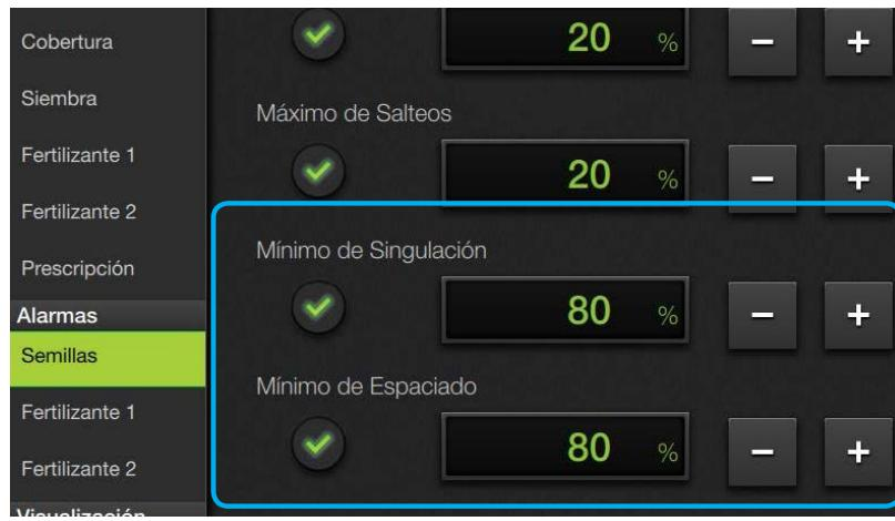
Para los datos de **Singulación**, las tolerancias se comparan con el valor de cada dato.
